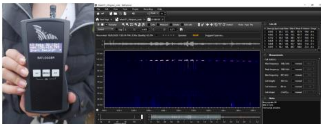
Slika 5 - Ultrazvučni uređaj Batlogger M s pripradajućim programom za analizu snimaka BatExplorer, Elecon
